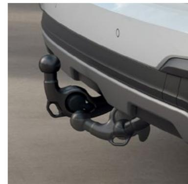
Con adaptador (para remolque)
